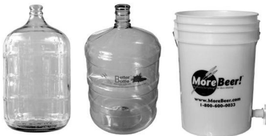
Figura 4.6: Fermentadores homebrew típicos: Better Bottle, plastic buck et. glass carboy. Fotos cortesia de MoreBeer.com.
