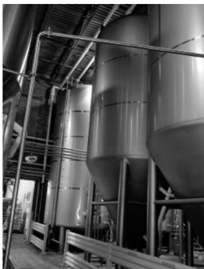
Figura 4.9 Fermentadores cilíndricos na Goose Island Beer Company. Foto cortesia de Peter Symons.
