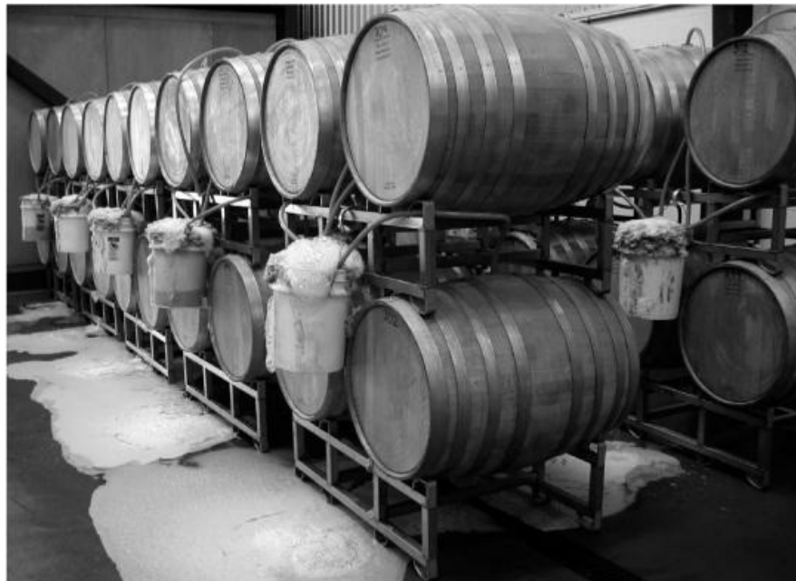
Figura 4.14: O sistema Firestone Union empurra a levedura marrom para fora dos barris, resultando em cerveja mais limpa. Foto cortesia de Matthew Brynildson.
