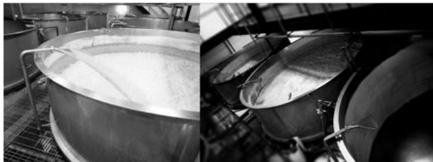
Figura 4.15: A Black Sheep Brewery em Masham, no condado de North York, usa um quadrado moderno e redondo de York feito de aço inoxidável. Fotos cortesia de Black Sheep Brewery.
