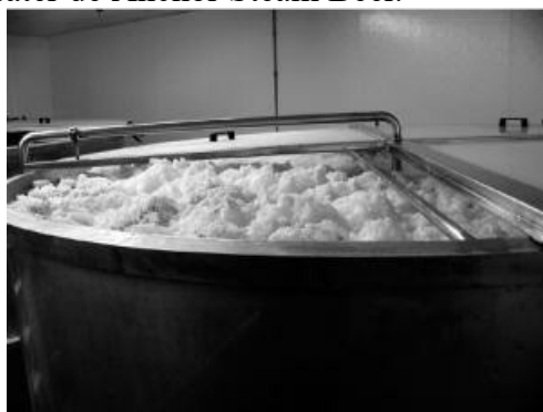
Figura 4.8: Fermentação aberta na cervejaria Magic Hat, South Burlington, Vermont. Foto cortesia de Teri Fahrendorf.
