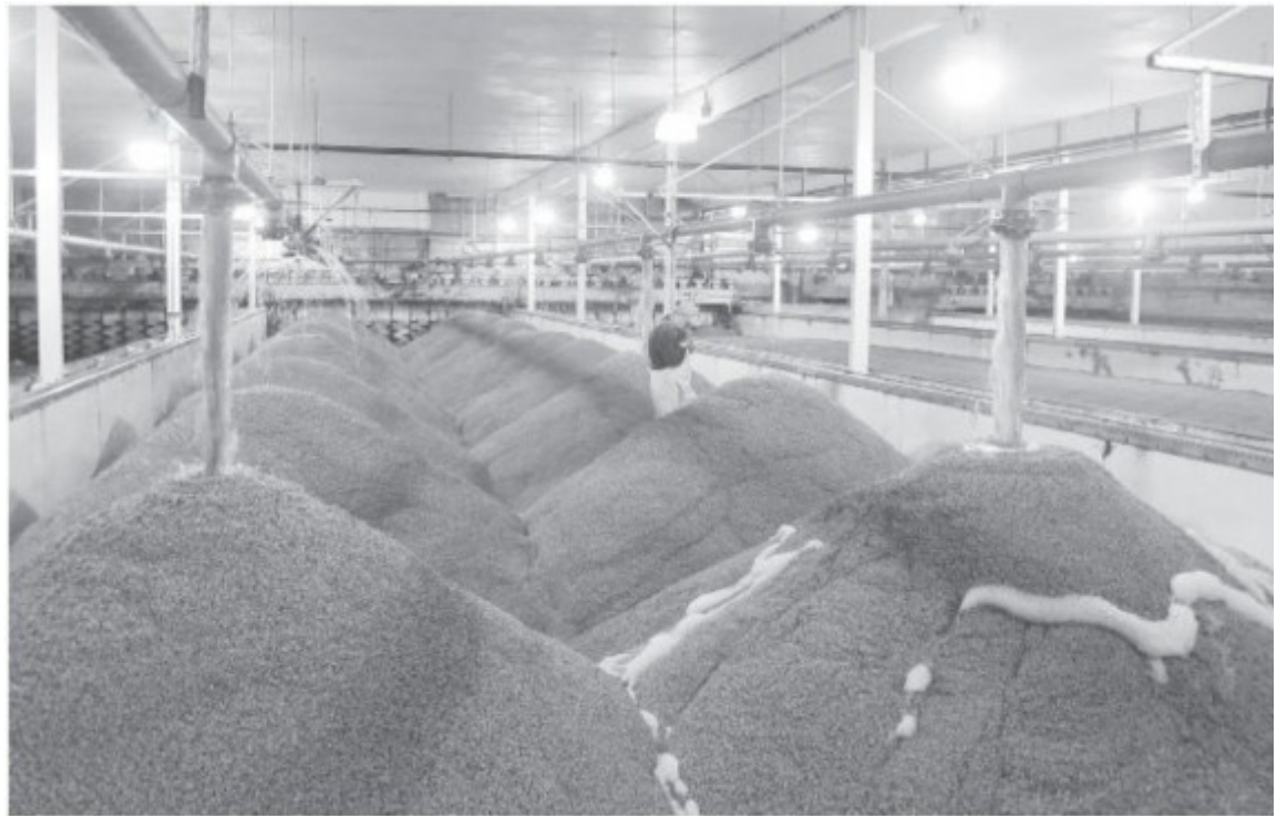
FIG. 4.2: Carregando as caixas de Saladin com grão do tanque íngreme s. A cevada é movida como uma pasta e sua distribuição na cama é controlada manualmente neste malthouse.
