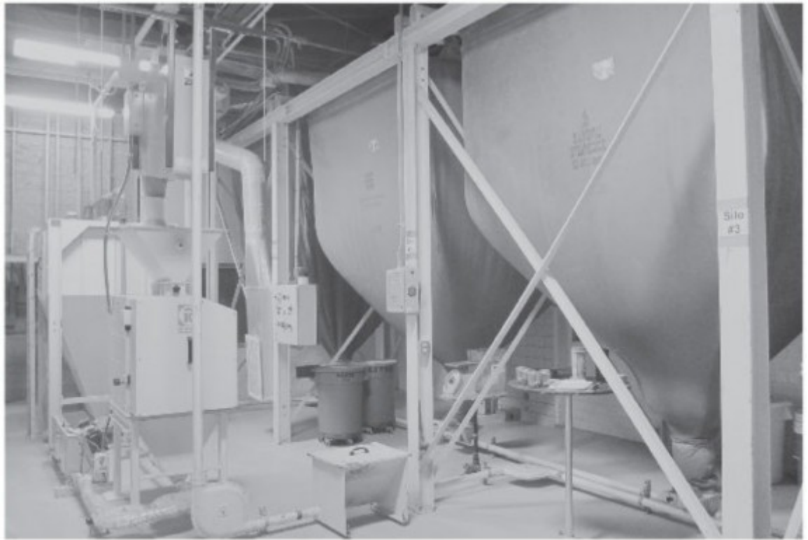
FIG. 11.2: Área de grãos bem dispostos na Starr Hill Brewery, em Crozet, Virgínia, com lixeira, moinho de 4 rolos, transportador de cadeia de discos e silos de armazenamento de malte de tecido. Um controlador de lote Feed-Pro é montado acima do moinho.
