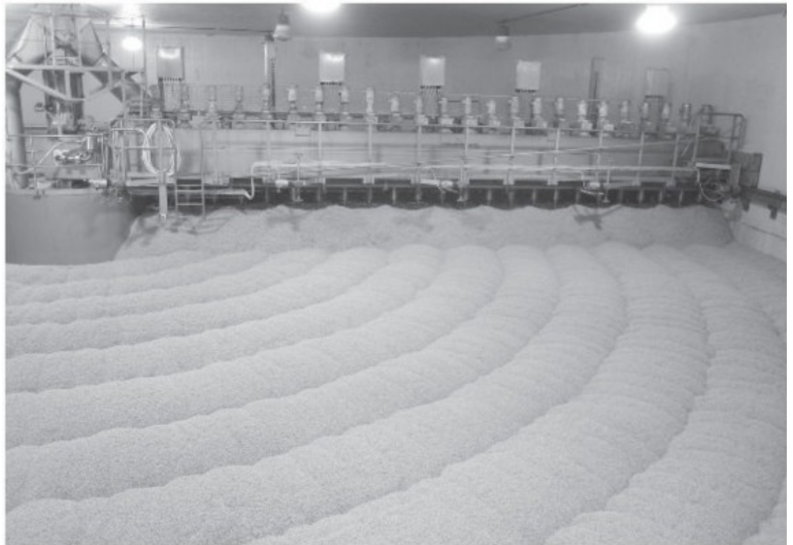
FIG. 4.1: Este leito de germinação Circular tem 92 m de diâmetro e 63 m de profundidade, possui 400 toneladas métricas de cevada por lote, a colheita de cerca de 200 acres de terras agrícolas locais.
