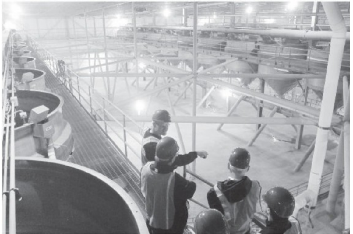
FIG. 4.3: Tanque íngreme em um malthouse moderno. 12 tanques são usados para cada lote de malte de 200 toneladas métricas (441.000 lb). Saladin caixa de germinação camas estão localizadas diretamente abaixo do tanque íngreme s.
