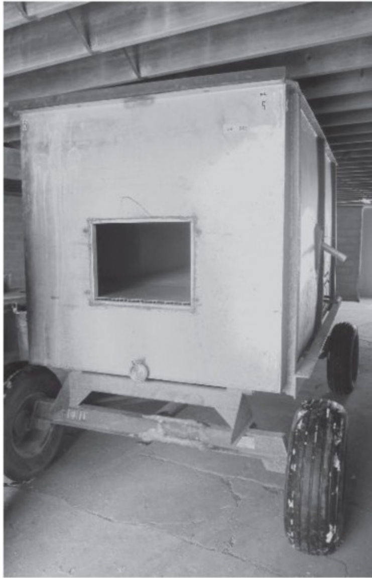
O vagão convertido do feijão em Michigan Malting. Ele pode ser usado para íngreme, germinar, e k iln um lote de malte.
